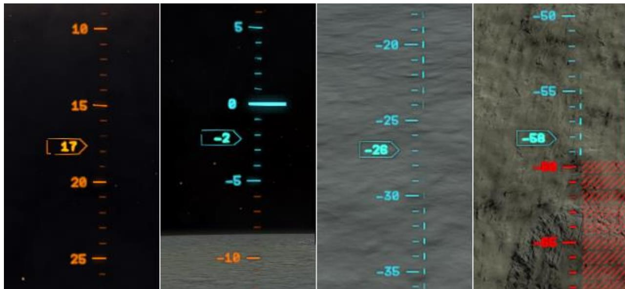
Авиагоризонт отображает тангаж и крен корабля относительно поверхности планеты. Числа на нем соответствуют тангажу (при 0 градусов корабль летит параллельно поверхности).
